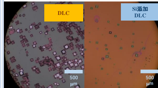
Siの添加によるDLC膜の耐薬品性能向上
