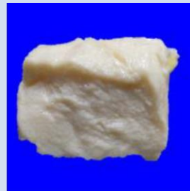
過冷却制御の一例(豆腐) 凍結時に組織保持 凍結時に組織破壊
