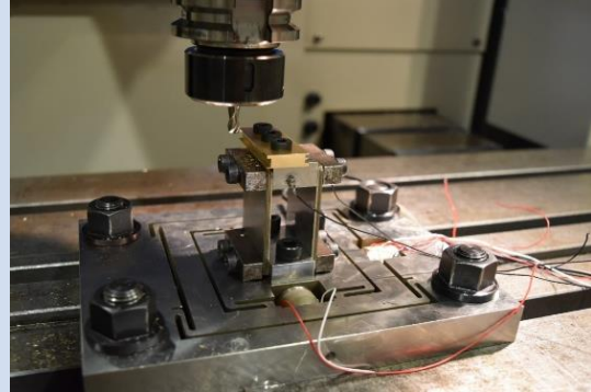
時間遅れ変動加振によるびびり振動抑制
