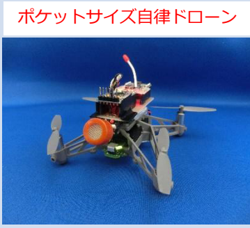
ポケットサイズ自律ドローン 手のひらサイズで自律飛行し化学物質を探索するドローン
